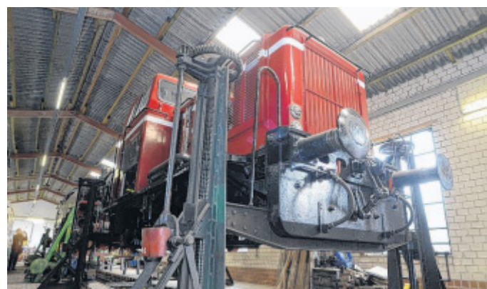
Aufgebockt: Die drei Radsätze der Lok DL 2 der Wittlager Kreisbahn werden derzeit aufgearbeitet. Die Eisenbahner hoffen, dass die Diesellok zu den Nikolausfahrten wieder in Betrieb genommen werden kann.
